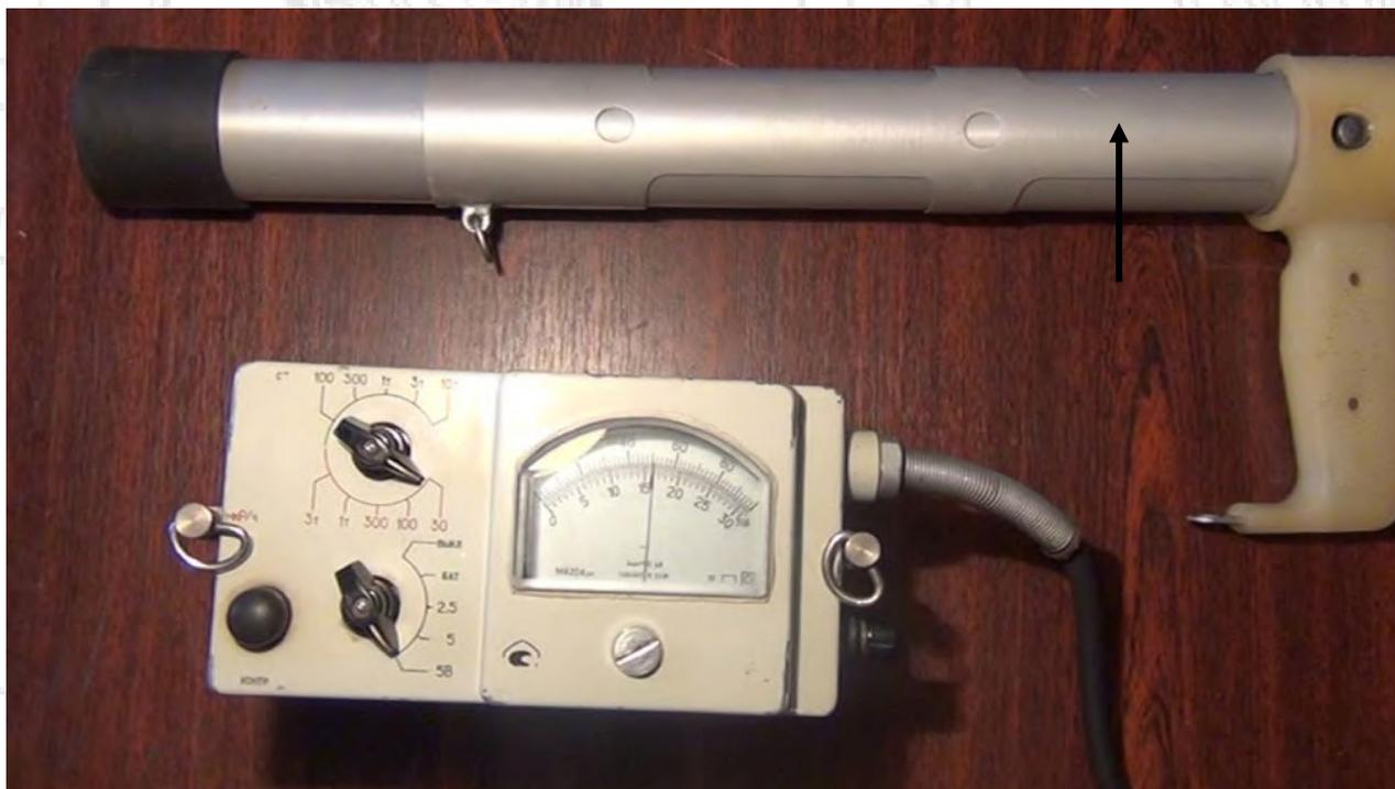
Рис.2 Общий вид радиометра СРП-68-01
