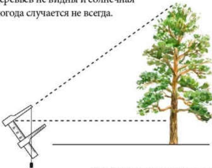
*Определение высоты дерева с помощью мерной вилки*
