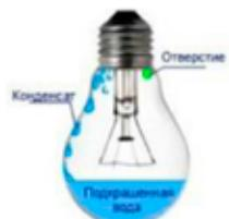
Когда отверстие будет просверлено, залить в него подкрашенную водопроводную воду, заполнив стеклянную колбу до половины. Остается подвесить барометр между оконными рамами, с северной стороны, где на него не будут попадать прямые солнечные лучи.
