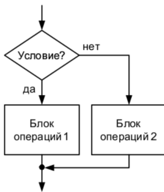
Рисунок 38. Блок-схема полного ветвления
