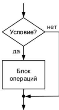
Рисунок 37. Блок-схема неполного ветвления
