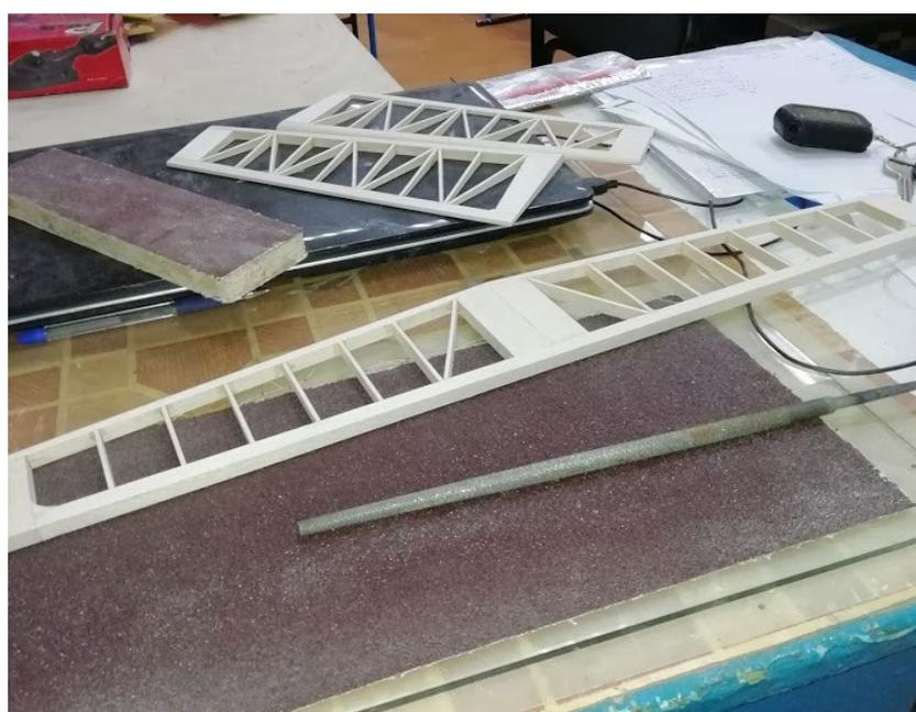
Рисунок 9. Изготовление стабилизатора
