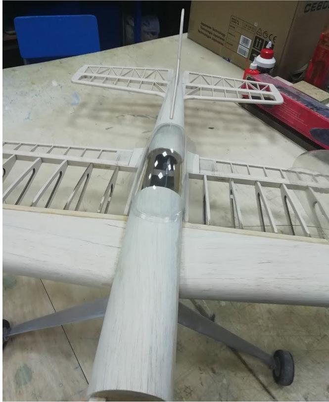
Рисунок 17. Установка кабины
