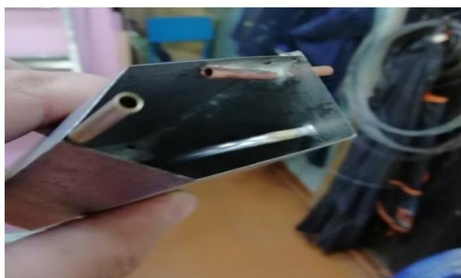
Рисунок 21. Изготовление топливного бака
