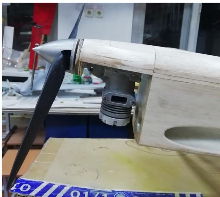
Рисунок 20. Установка кока и винта
