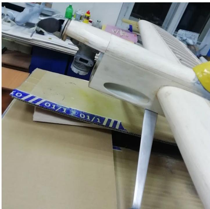
Рисунок 19. Установка двигателя
