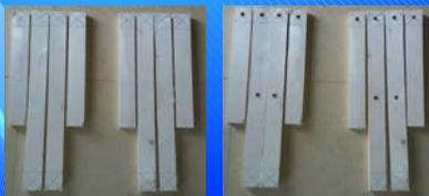
4. Разметка для болтового соединения и сверление отверстий для втулок.
