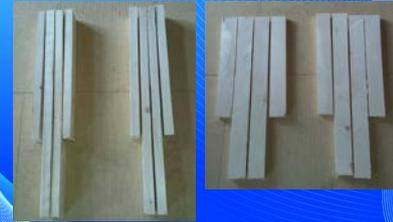
3. Скругление краёв реек, зачистить боковые поверхности и торцы деталей, шлифовка.
