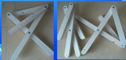
6. Сборка: соединение крышки и распорок саморезами.
