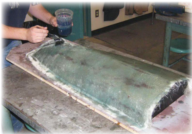
Рисунок 8. Покрытие корпуса эпоксидной смолой
