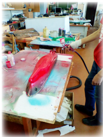
Рисунок 14. Окраска корпуса модели
