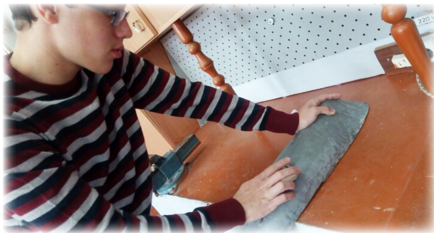
Рисунок 9. Обработка корпуса наждачной бумагой средней зернистости
