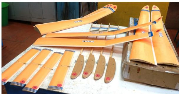
*Рис. 7. Детали модели F-1-A*
