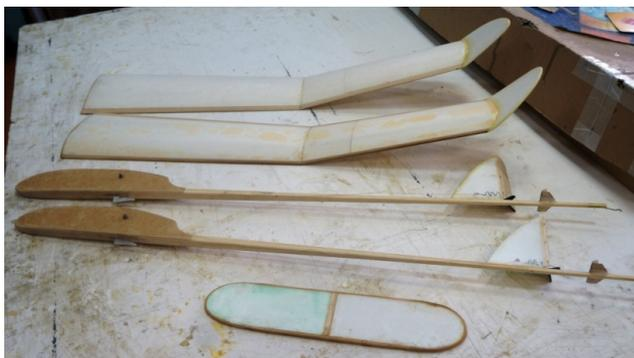
**Рис. 5. Модель планера F-1-H**
